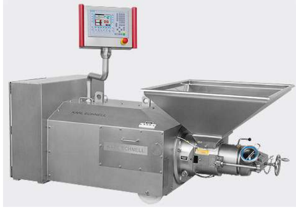
Typ FD 175 D Emulsifier 175 mm Ayna Çapı ( Kapasite : 2.500.-Kg / Saat )
