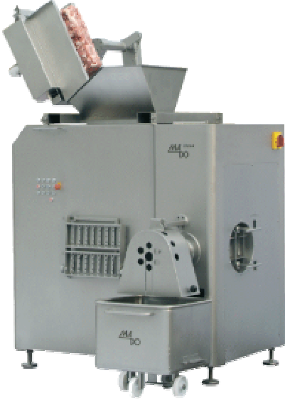
Endüstriyel Tip Donuk Blok Kıyma Makinesi Ayna Çapı 160 Ø mm
