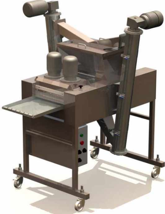
Kaplama ve Toza bulama Hattı
